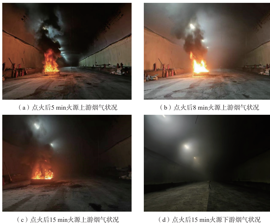
图11 关闭负离子净化器状态下隧道内的烟气状况
